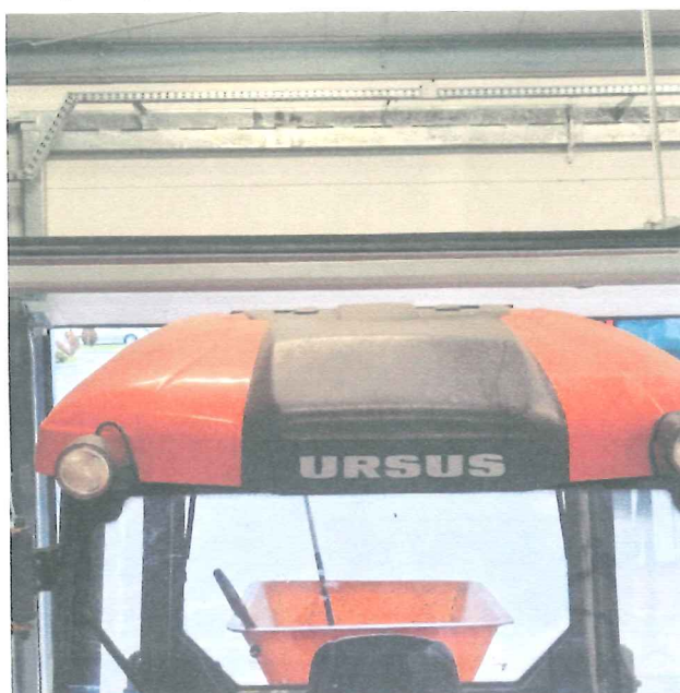
Fot. 2 Minimalny prześwit pomiędzy konstrukcją bramy, a traktorem
